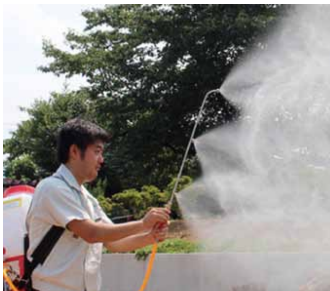
25L も入る背負い式エンジン噴霧器。ミネラルや有機液肥を散布する。
