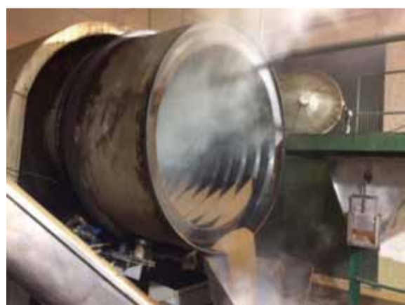
焙煎機ロータリーキルン。鉄の蓋を外し、外側から加熱する。
